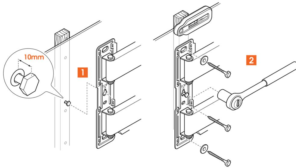
5. Fija el **soporte de pared** (A) a los montantes de madera con los **tornillos** (H) y las **arandelas** (J). Usa el **nivel de burbuja** (C) para nivelar el soporte de pared. Asegúrate de introducir primero el tornillo central en la pared.
