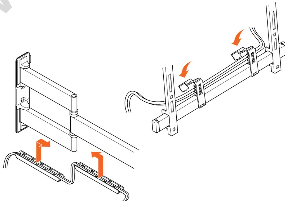
3. Retira las cubiertas del brazo de cables deslizándolas y tirando de ellas hacia fuera.
