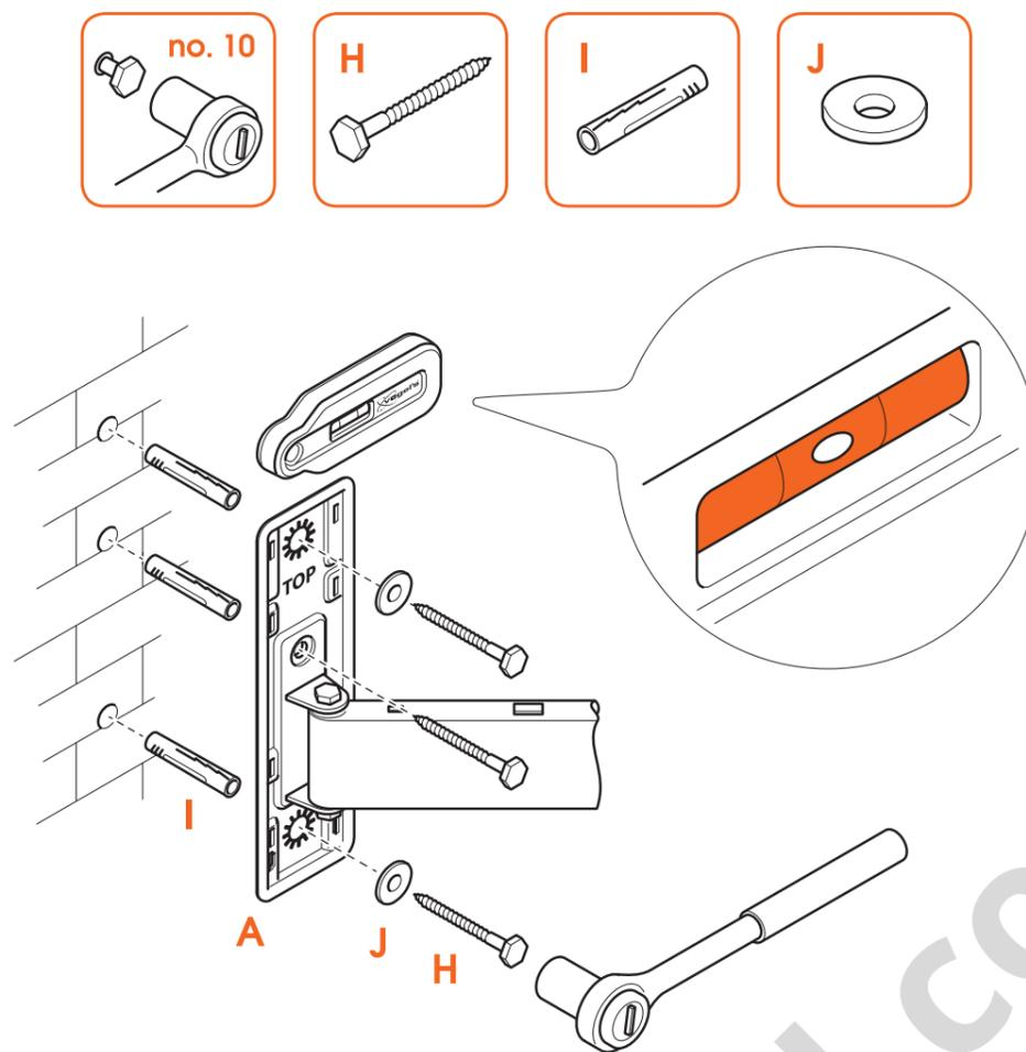
2. Fija el **soporte** (A) a la pared con los **tornillos** (H), las **arandelas** (J) y los **tacos** (I). Usa el **nivel de burbuja** para nivelar el soporte de pared.
