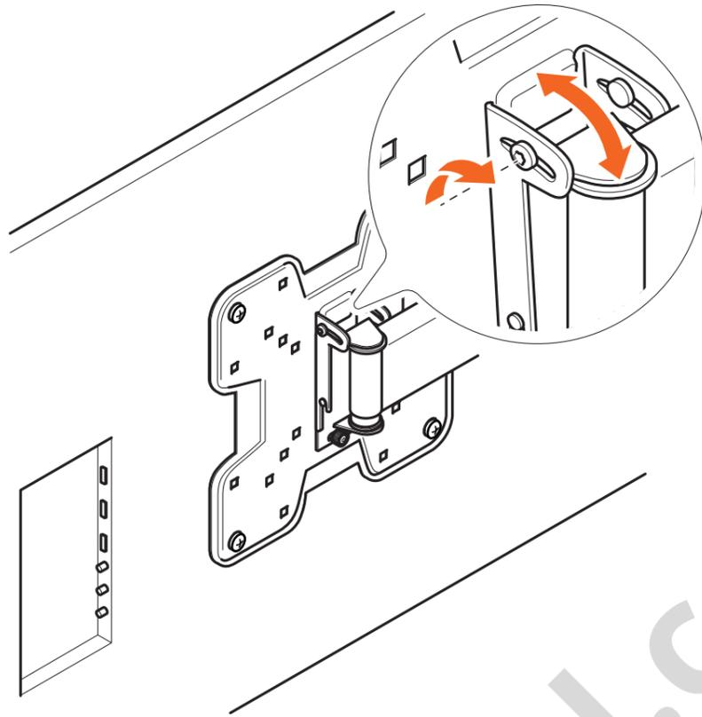
1. Afloja los dos pernos de ambos lados con una llave Allen de 4 mm; no los retires completamente.
