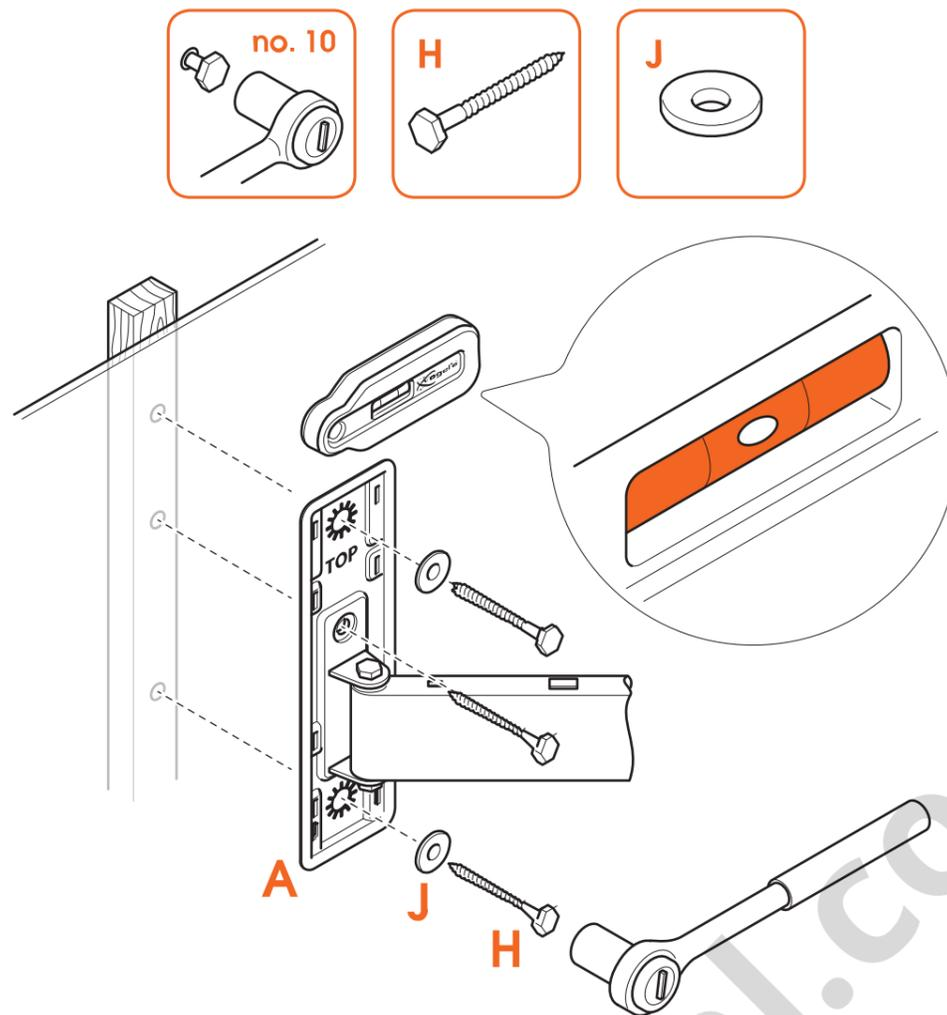
5. Fija el **soporte de pared** (A) a los montantes de madera con los **tornillos** (H) y las **arandelas** (J). Usa el **nivel de burbuja** para nivelar el soporte de pared.
