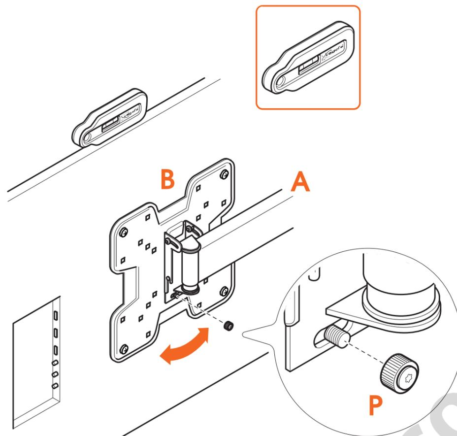
2. Fija la **placa del adaptador** **B** al **soporte de pared** **A** con la **tuerca de mariposa** **P** y apriétala con una llave Allen. Comprueba que el TV esté nivelado utilizando el **nivel de burbuja**. Nivelá el TV mientras está paralelo a la pared y coloca el nivel de burbuja encima del TV.
