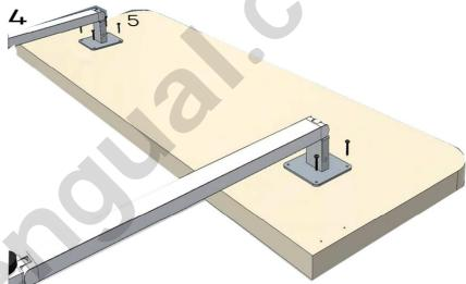
COLOCAMOS EN LA PARTE INFERIOR DEL MODULO (EN EL PUNTO PREVIAMENTE MARCADO) LA PIEZA DE ZAMAK PARA SUJETAR LA PATA
