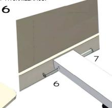
SUJETAMOS CON LOS TORNILLOS LA PATA A LA PIEZA DE ZAMAK
