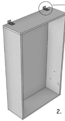
2. POR SEGURIDAD, IMPRESCINDIBLE SUJETAR EL MODULO A LA PARED, CON LOS ANGULOS INDICADOS.
