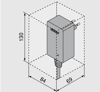
**i** Para facilitar la circulación del aire, se debe mantener una distancia de seguridad de 30 mm (véase el gráfico) para no sobrecalentar la fuente de alimentación de SERVO-DRIVE o la fuente de alimentación enchufable de SERVO-DRIVE.
