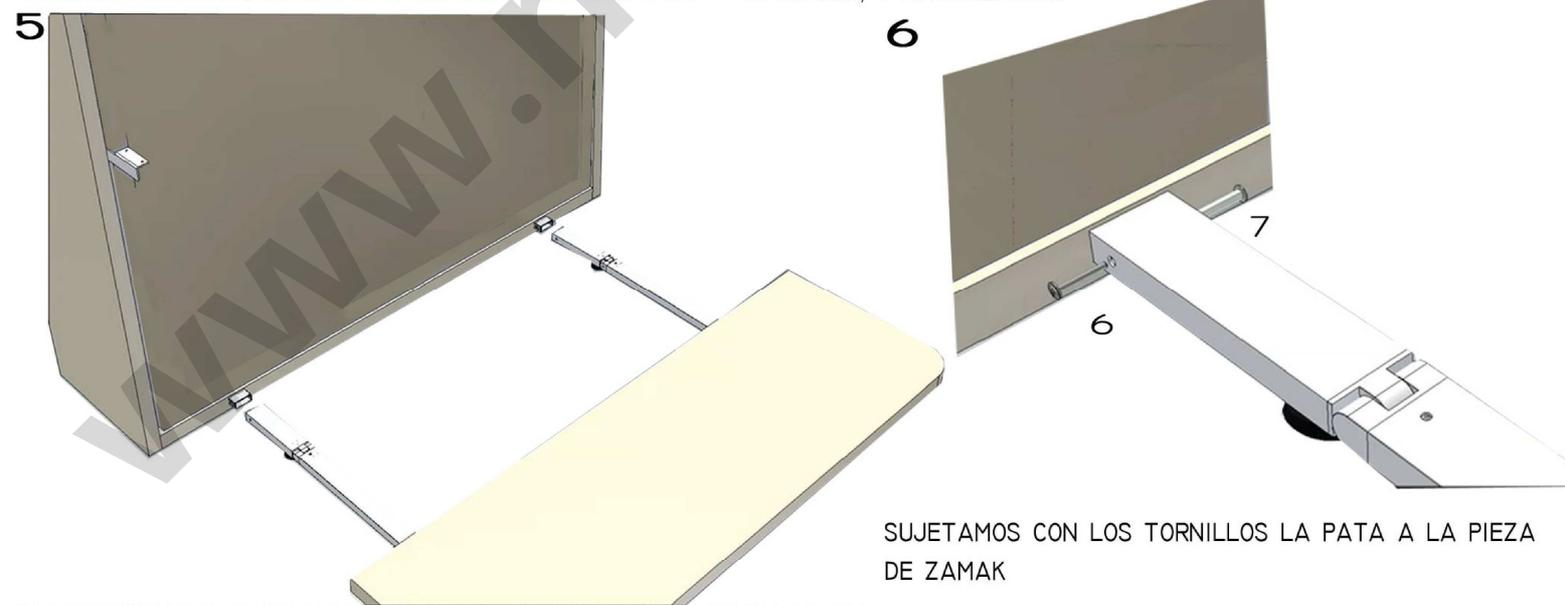
INTRODUCIMOS EL OTRO EXTREMO DE LAS PATAS EN LOS SOPORTES DE ZAMAK QUE HEMOS COLOCADO EN EL MODULO.
