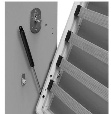
8. Subimos el bastidor para poder colocar el pistón en el soporte superior.
