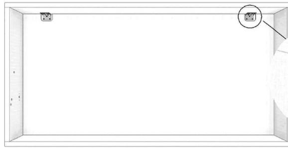
2. POR SEGURIDAD, IMPRESCINDIBLE SUJETAR EL MÓDULO A LA PARED, CON LOS ANGULOS INDICADOS.
