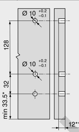
\* +1 mm si las guías de cuerpo se instalan antes de montar el cuerpo
