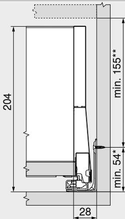
\* +1 mm si las guías de cuerpo se instalan antes de montar el cuerpo
