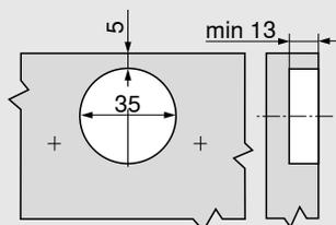
**Montaje INSERTA | por encaje a presión**
