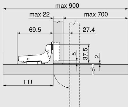
Cotas de la bisagra con ajuste en fábrica (distancia de la base = 0 mm)
