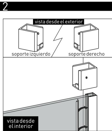
Colocar los soportes pared. Fijarse en la imagen para colocar cada uno en su posición correcta.
