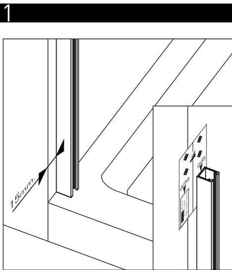
Limpiar bien la superficie donde va a ir la mampara. Colocar el "soporte pared", si la mampara va montada en la esquina se debe poner a 15mm. del canto del plato. Poner a nivel y retirar el protector del adhesivo QuickSystem y pegar fuertemente. Con la ayuda de la plantilla, taladrar donde irá el "soporte guía". Repetir el mismo proceso en el otro lado.
