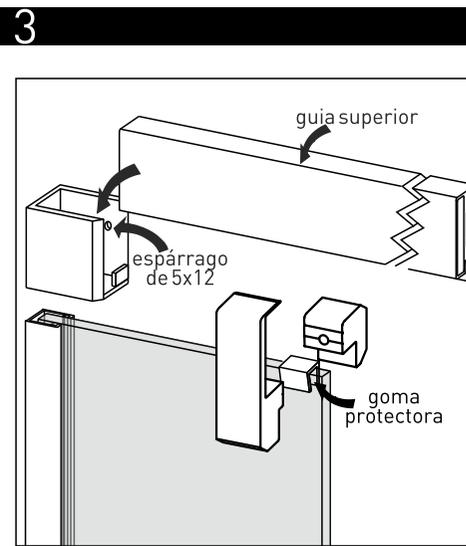
Las guías se deben cortar a 1cm. menos de la medida de la mampara por la parte recta. Unirlas con la escuadra, introducir en los soportes guía y atornillar los espárragos hasta bloquear las guías. Montar el conjunto pinza fijo como en la imagen y unir con el tornillo con cabeza cónica. Dejar todo el conjunto pinza fijado a 5mm. del canto del vidrio fijo.
