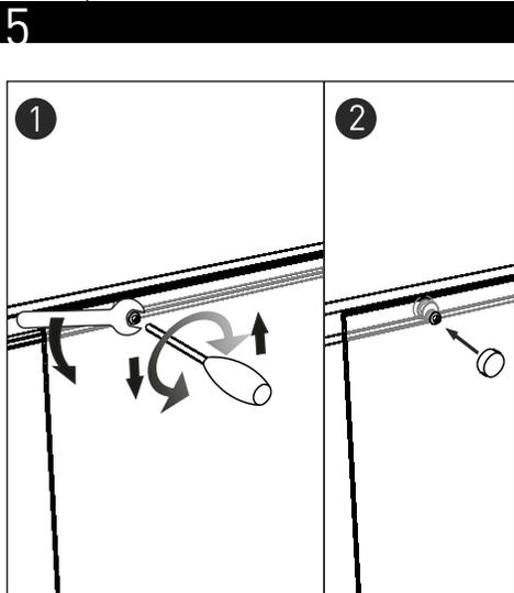
Para ajustar el desnivel de la puerta, aflojar ligeramente la tuerca y con la ayuda de un destornillador girar hacia la derecha para subir la puerta y hacia la izquierda para bajar la puerta. Una vez regulada, apretar la tuerca para que se bloquee la rueda. Después colocar el tapón embellecedor.
